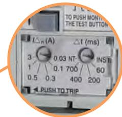
→ Регулируемый ток утечки в пределах 30mA - 300mA. Регулируемая задержка отключения при срабатывании защиты от утечки тока на землю в пределах 60ms - 700ms, включая функцию INST (мгновенное отключение) и NT (не отключает)
