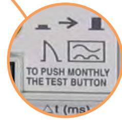
→ Тип A: для переменного и пульсирующего постоянного токов утечки
